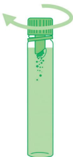
Drehen Sie die Verschlusskappe im Uhrzeigersinn bis der Sicherheitsring bricht und **weiter** bis zum Anschlag nach unten.
